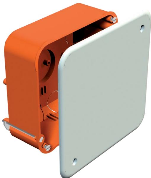
Соединительная коробка для полых стен, 20 пробивных отверстий для кабелей NYM, кабелей передачи данных и труб Ø 20 мм, с крышкой и винтами крышки, с белыми крышками и винтами (огнестойкость согласно VDE 0471 / DIN 695 часть 2-1, температура испытания 750 ° C), для толщины панели 7 -35 мм. Подходит для установки стандартных реек (цилиндрических реек и монтажных реек) для клеммных блоков, класс защиты IP30.
