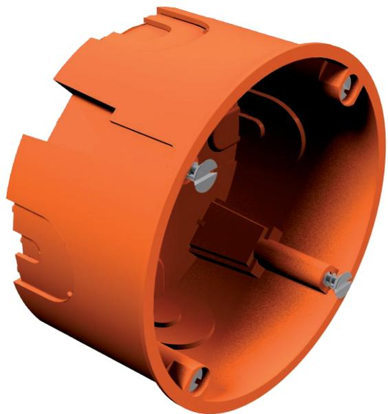
Монтажные коробки для полых стен. Размеры согласно DIN 49073-1, для пластин толщиной 7 – 35 мм. Стандартное расстояние 71 мм, возможность сквозного соединения с помощью переходника при комбинировании между монтажными коробками и соединительными коробками, 8 продавливаемых мембран для кабеля NYM, кабеля передачи данных и труб Ø 20 мм,
