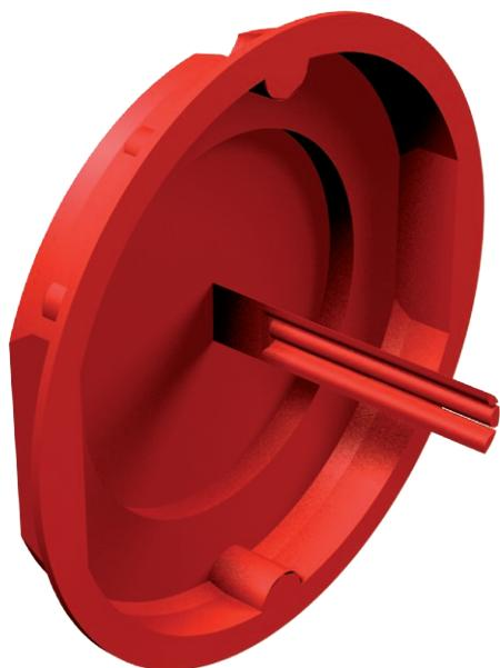
Красные сигнальные крышки защищают внутреннюю часть коробки при нанесении штукатурки. Маркировочные метки позволяют легко определить крышку после нанесения штукатурки. Красные сигнальные крышки можно использовать многократно. После нанесения штукатурки необходимо легко надавить на розетку и снять сигнальную крышку.
