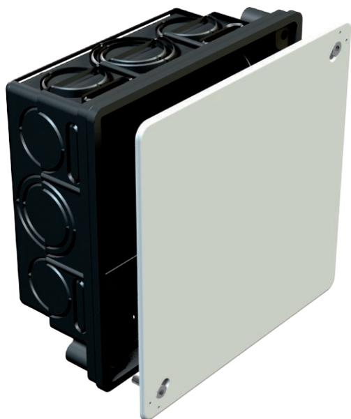
Распределительная коробка для фиксации клемм, с крышкой и винтом (15 мм); крышка прилегает к коробке в одной плоскости; поверхность шероховатая, в сочетании с крышкой и винтами распределительные коробки имеют отметку о сертификации VDE в соответствии с VDE 0606 и считаются огнестойкими по VDE 0471/DIN 695, часть 2-1; контрольная температура 750 °C, степень защиты IP20.
