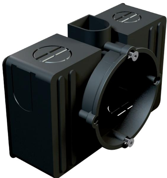
Монтажная коробка с увеличенным внутренним объемом для монтирования в нее соединительных зажимов. С защитой от переключения (по стандарту DIN 49 073-1) благодаря муфте с фиксирующей защелкой. Комбинируется для распорного и винтового крепления, углубленных креплений в штукатурке, расстояние между винтами 60 мм. Для винтового крепления с помощью саморезов 3,2 мм, с 2 точками для винтов, без винтов, степень защиты IP20.
