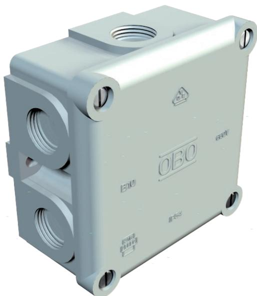
Степень защиты IP54, номинальное напряжение 660 В, номинальное сечение 2,5 - 4, в комбинации с клеммной колодкой 700/6 М номинальное сечение коробки составляет 4 мм<sup>2</sup>, 2 крепежных отверстия для винтов диаметром до 5 мм, расположенных снаружи коробки. 4 винта крышки, 7 мембранных вводов с резьбой M20 x 1,5, преимущественно для кабельных вводов с короткой соединительной резьбой. Внутренние размеры: 80x80x39 мм.
