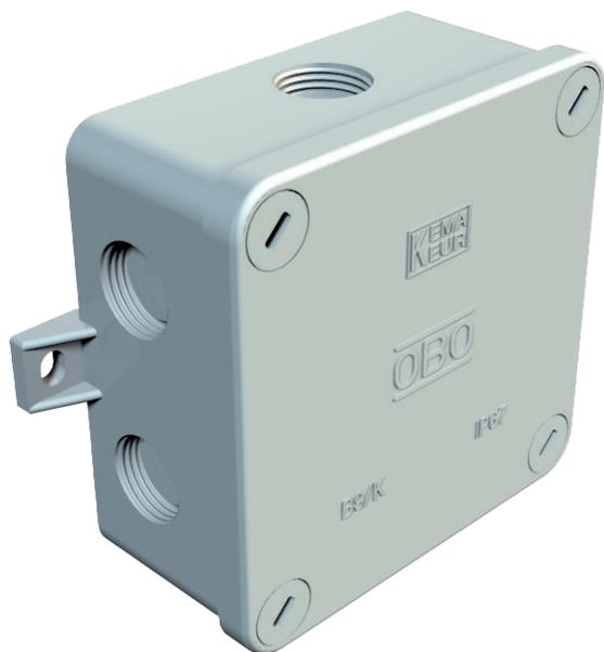
Степень защиты IP67, пустой короб для использования с отдельными клеммами, 4 винта из пластика, поэтому абсолютно устойчивы к коррозии, 2 крепежных лапки для винтов до 5 мм Ø, 7 мембранных вводов с резьбой M20 x 1,5 3 кабельных ввода из полиамида для диаметра кабеля 9-12 мм тип 106 М.
