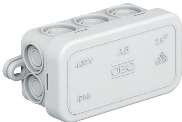
Степень защиты IP55, номинальное напряжение 400 в, номинальное сечение 2,5 ÷ мм<sup>2</sup>, 6 вводов для кабеля диаметром 5-14 мм
