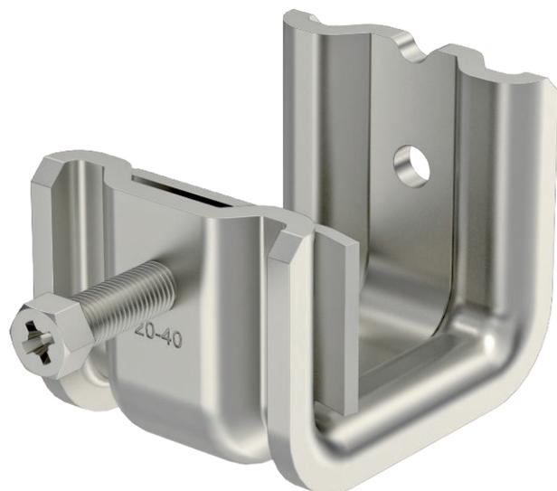
Этот вид балочного зажима устанавливается на опору и фиксируется с помощью прижимной пластины и винта (M8) на опоре или полосовой стали. Болт имеет ширину 10 мм. В корпусе скобы имеется также 2 резьбы M8, например, для крепления стержня с резьбой.
