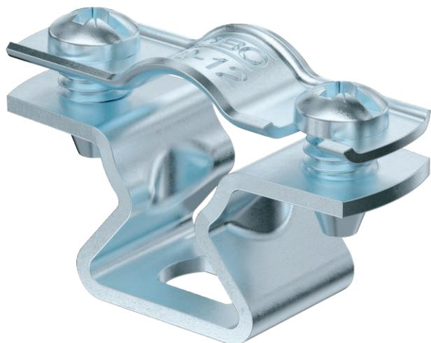
Дистанционная скоба для монтажа труб и кабелей на стене, потолке и на полу. С самоблокирующейся верхней частью. Крепление через продольное отверстие. Начиная с размера 20, скобы можно монтировать с помощью устройства для забивания гвоздей и прибора для установки болтов.
