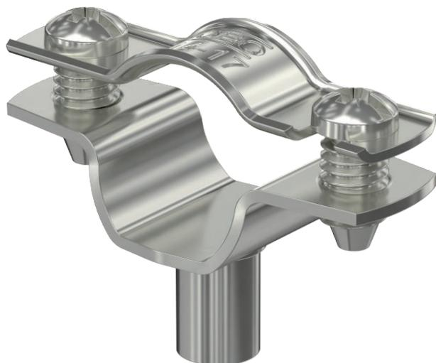
Дистанционная скоба для монтажа труб и кабелей на стене, потолке и на полу. С самоблокирующейся верхней частью. Крепление при помощи выступа с внутренней резьбой. Варианты скоб с покрытием G и FT, начиная с размера 20, можно монтировать с помощью устройства для забивания гвоздей и прибора для установки болтов. Допуск к эксплуатации согласно DIN 4102, часть 12, классы огнестойкости от E30 до E90.
