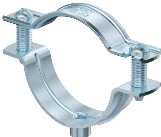
Дистанционная скоба для монтажа труб и кабелей на стене, потолке и на полу. С самоблокирующейся верхней частью. Крепление при помощи выступа с внутренней резьбой. Варианты скоб с покрытием G и FT, начиная с размера 20, можно монтировать с помощью устройства для забивания гвоздей и прибора для установки болтов. Допуск к эксплуатации согласно DIN 4102, часть 12, классы огнестойкости от E30 до E90.
