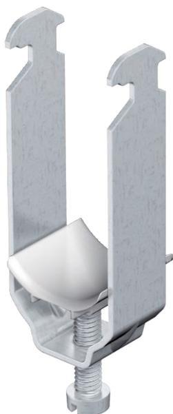
Подходит для всех С-образных профильных реек с прорезью шириной 16 - 17 мм; скоба и винт из алюминия ALMg 3, пластинка из полипропилена, не содержит галогенов, светлосерый RAL 7035.
