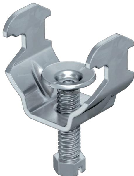
Для крепления полосовых заземлителей шириной до 30 мм к профильным рейкам, подходит для всех профильных реек со шлицем шириной 16-17 мм.
