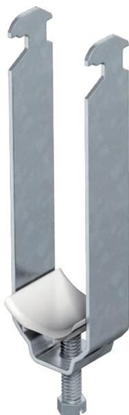
Подходит также для всех профильных С-образных реек со шлицем шириной 16-17 мм. Скоба и винт из стали горячего цинкования, полипропиленовая прижимная пластина, не содержит галогенов, светло-серая RAL 7035.
