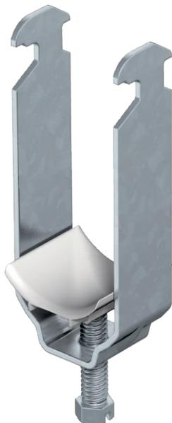
Подходит также для всех профильных С-образных реек со шлицем шириной 16-17 мм. Скоба и винт из стали горячего цинкования, полипропиленовая прижимная пластина, не содержит галогенов, светло-серая RAL 7035.
