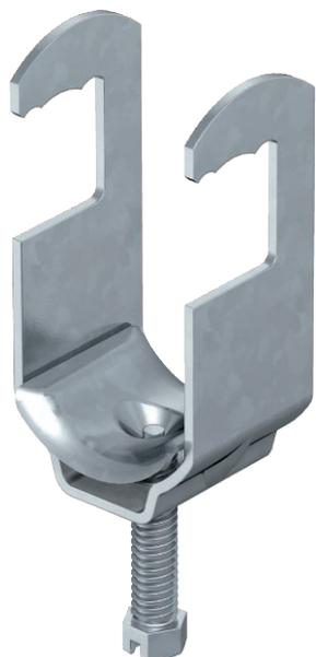
Подходит для круглого профиля или труб диаметром до 22 мм, скоба, прижимная пластинка и винт из стали, горячее цинкование; металлические пластины имеют со всех сторон сильно закругленные края, что исключает возможность повреждения кабеля.
