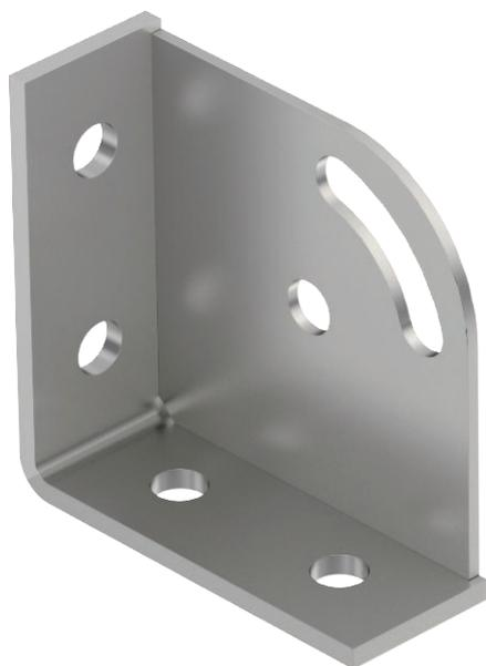
Усиленный монтажный уголок с 6 отверстиями для соединения профильных реек 41 x 41 мм и 41 x 21 мм под углом 90°. Дополнительная возможность крепления стойки под углом 45° с возможностью регулировки + / - 30°. Может использоваться для углов от 15° до 75°.
