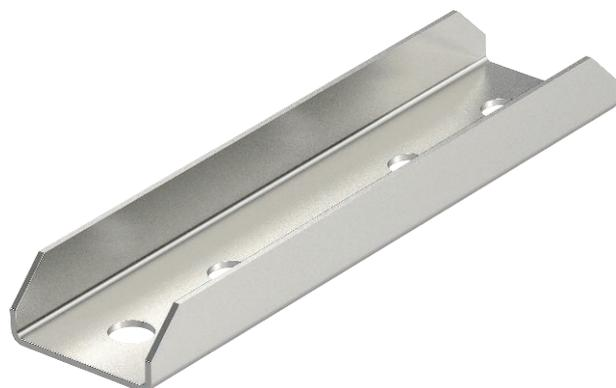
Располагающийся снаружи соединитель с 4 отверстиями для продольного соединения профильных реек 41 x 41 мм и 41 x 21 мм
