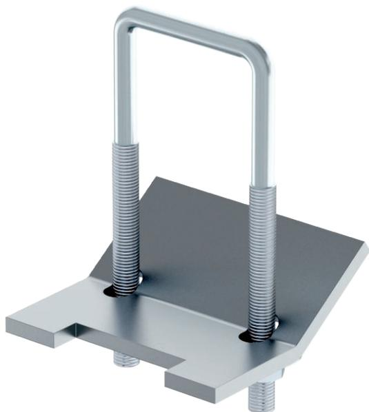
Соединительный элемент для крепления профильных реек к стальным балкам с двух сторон. Крепление возможно независимо от расположения отверстия. Длина рейки должна быть не менее ширины стальной балки + 2 x 50 мм.
