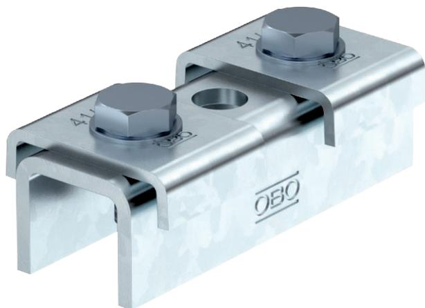
Соединитель служит в качестве удлинителя монтажной рейки MS4141. Это соединение может быть легко и надежно выполнено прямо на месте установки или же предварительно собрано в мастерской.
