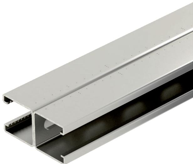
Профильная/монтажная рейка усиленной конструкции со сквозной перфорацией на дне и шириной шлица 22 мм. С двойной конструкцией, то есть две профильные рейки соединены друг с другом (спаяны).
