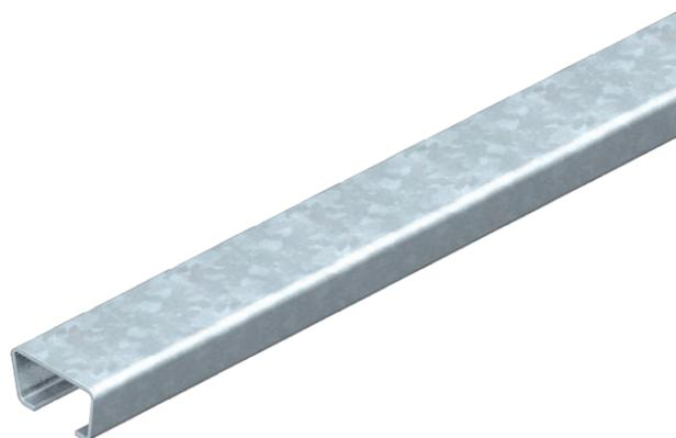
C-образная профильная рейка подходит для прокладки кабеля в сочетании с зажимной скобой с прямоугольной лапкой. Также используется в качестве подвесной конструкции для систем прокладки кабеля.
